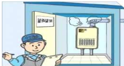
보일러실 배기통 점검
