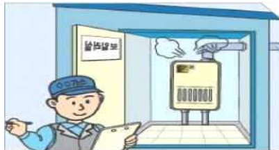
보일러실 배기통 점검
